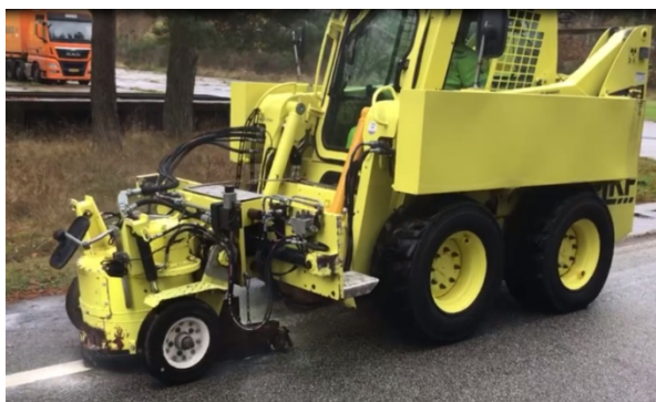
Figur 8.5 Eksempel på metoder til skånsom fræsning af kørebaneafmærkning med tallerkenfræser.
