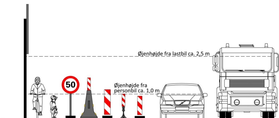
Figur 5.4 Almindelige øjenhøjder fra henholdsvis personbiler og lastbiler.
