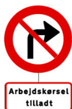
Figur 5.34 Eksempel på C 11 med undertavle som forbyder indkørsel til arbejdsområdet.
