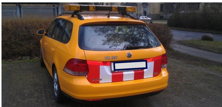
Figur 7.23 Eksempel på afmærkning af tilsynskøretøj med lygtebro og lodrette røde reflekser og hvid ureflekerende.
